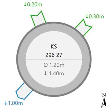
Schéma de chambre avec entrées et sortie
